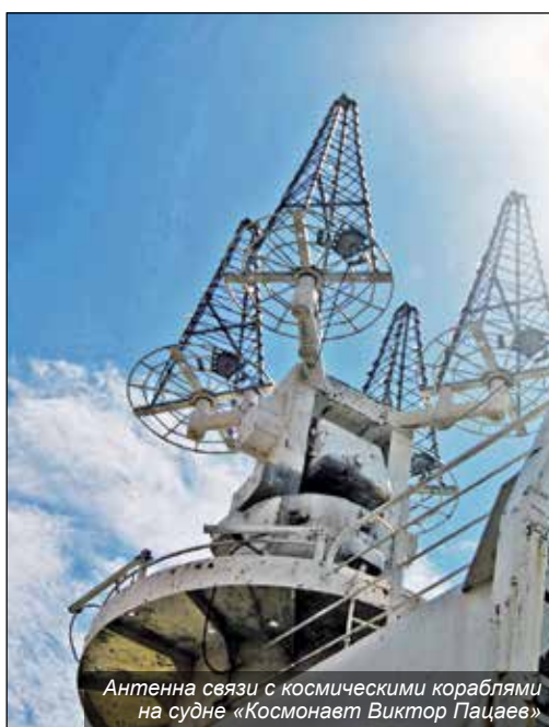
Антенна связи с космическими кораблями на судне «Космонавт Виктор Пацаев»
